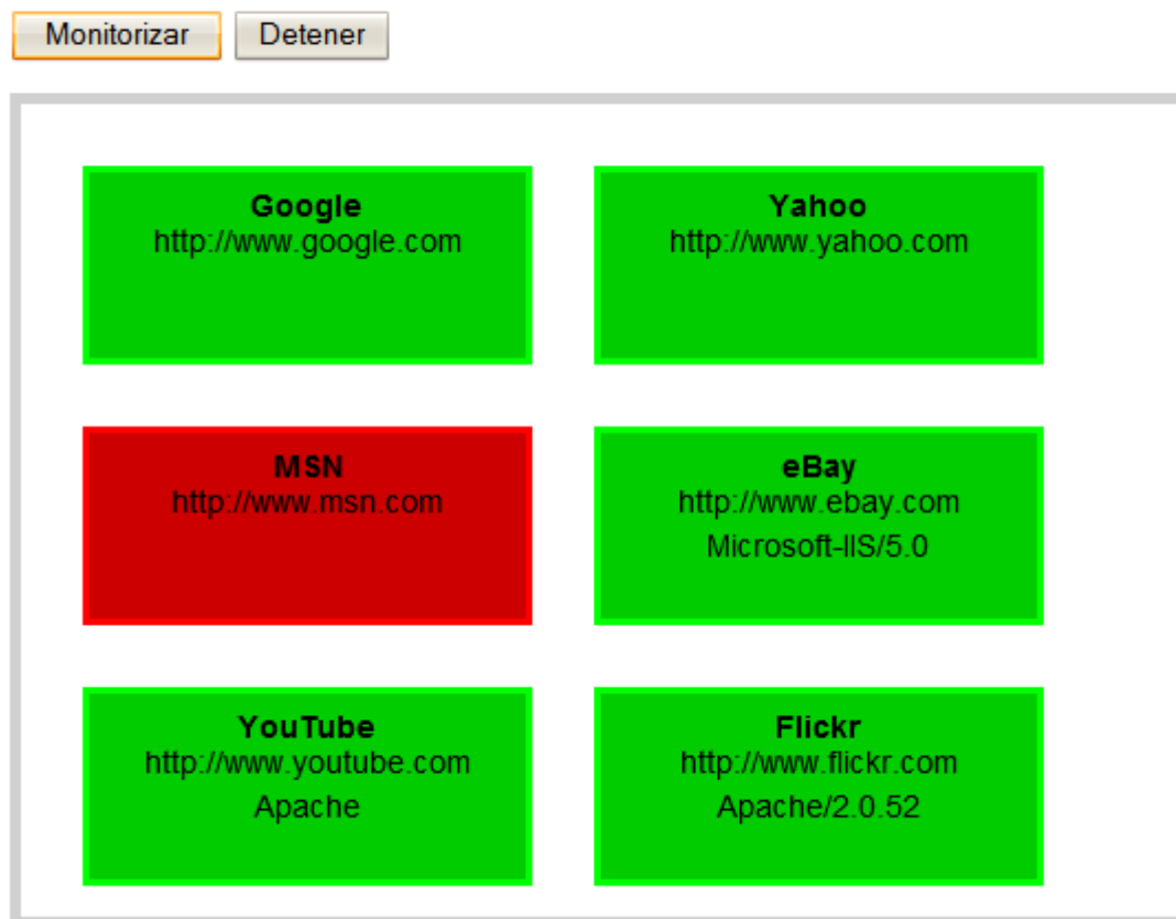
Figura 9.2. La consola de monitorización muestra visualmente el estado de cada nodo y también muestra parte de la información devuelta por el servidor
