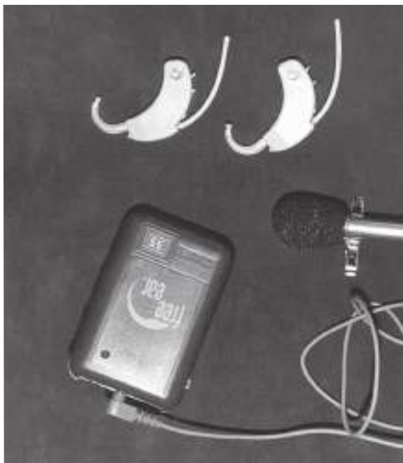
Foto 3: Sistema de Freqüência Modulada (FM) com microfone/transmissor (professor) e receptor (aluno).
